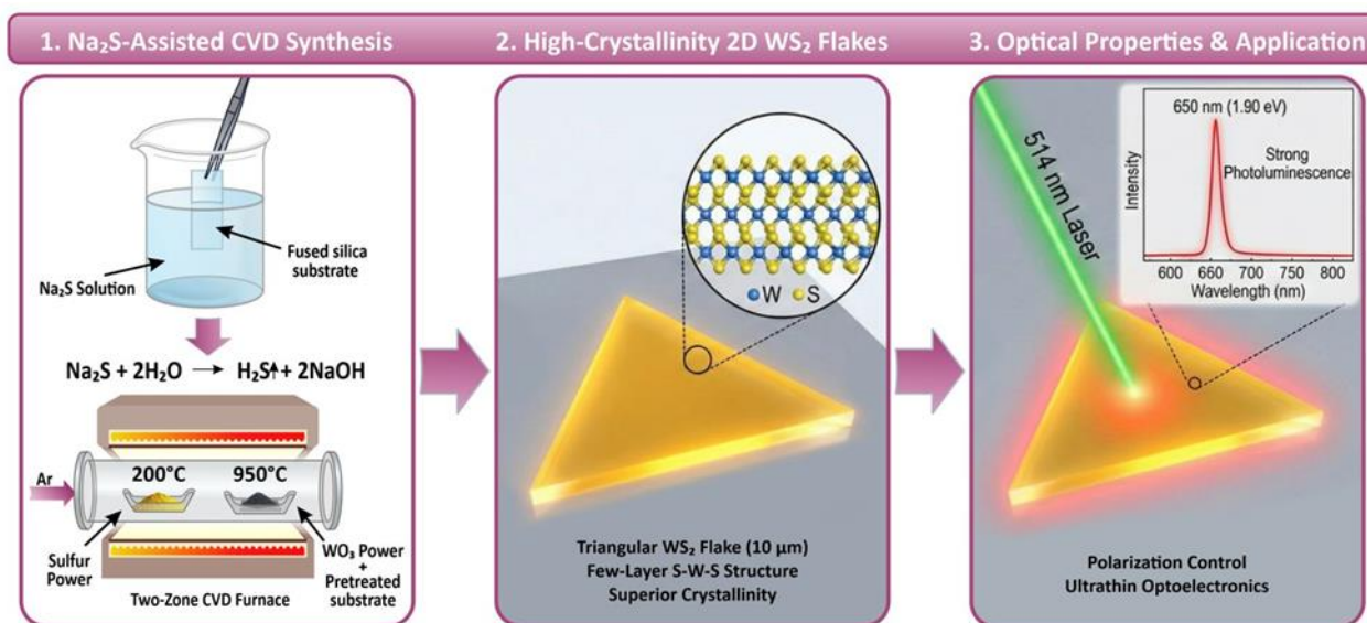
Фигура 6. Схематично представяне на Na 2 S-подпомогнат CVD синтез, получаване на висококристаллни 2D WS 2 люспи и изследване на техните оптични свойства и приложения в ултратънки оптоелектронни устройства.
